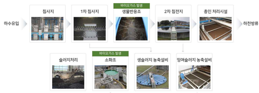
[그림 2] 하수처리 공정도 및 바이오가스 발생 지점 (출처: 동두천시 홈페이지)
